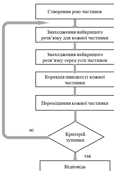
Рис. 3. Блок-схема алгоритму рою частинок
